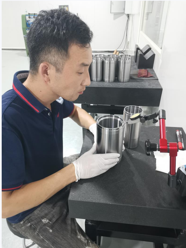
隔环的精度检测
